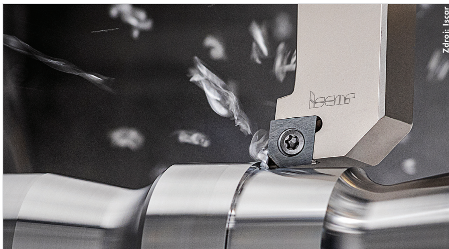
Obr. 4. Nástroje s břitovými destičkami s pájeným PCD břitem umožňují vysoce efektivní soustružení s vynikající kvalitou obroběného povrchu.
