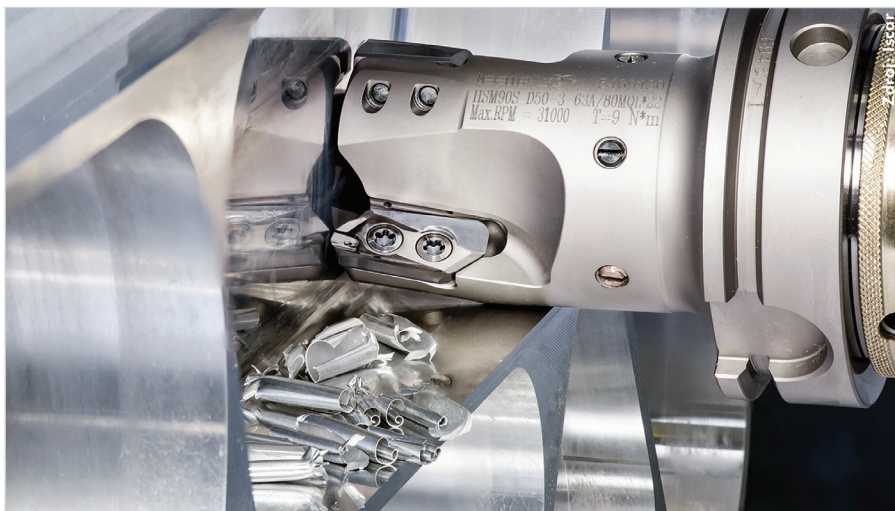
Obr. 1. Sortiment nástrojů Iscar zahrnuje širokou škálu řešení speciálně navržených pro obrábění lehkých materiálů, jako jsou slitiny hliníku a titanu – vyobrazena integrální 90° stopková fréza z řady HeliAlu s upínací stopkou HSK.
