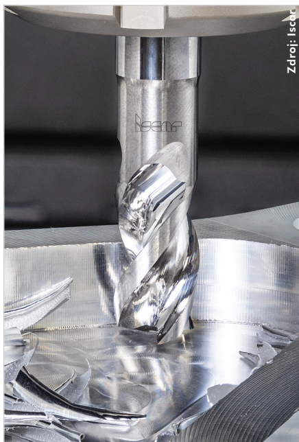
Obr. 3. Monolitní stopkové frézy Chatterfree s nepravidelnou zubovou roztečí a nestejným úhlem šroubovice pro max. úběr materiálu při obrábění hliníku vysokými posuvy.
