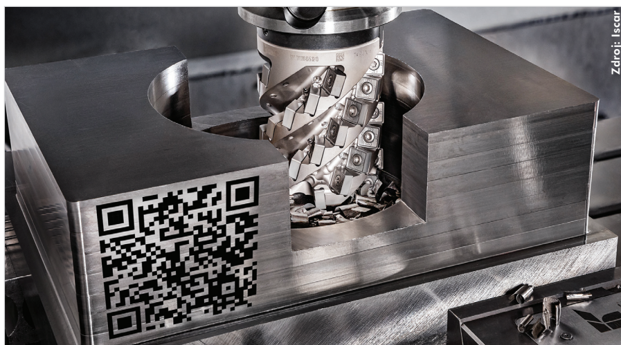
Obr. 2. Čelní válcové frézy S890 SM z řady Quick-X-Flute využívají oboustranné čtvercové destičky s geometrií optimalizovanou pro těžké hrubovací frézování titanu.
